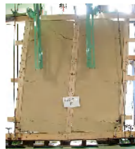
伝統的軸組構法の木造土壁せん断耐力試験 (2000、2003)
